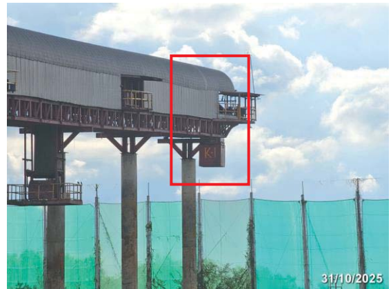
รูปที่ 3-7 ท่อโปรยทรายอ้อย (Chute)
